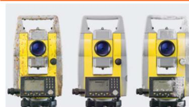
Com a Tecnologia de alta precisão em medição sem prisma, pontos com até 350m podem ser medidos e 3500m com prisma. Com compensador eletrônico avançado, a estação estará sempre nivelada e com erros de colimação corrigidos, assim obtém-se a máxima confiança nos ângulos horizontal e vertical.
